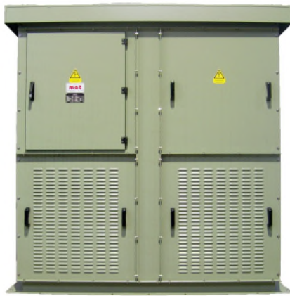
NOSPE-Widerstand im Stahlblechgehäuse 30kV, 2000A, 5s mit Trennlasche und Stromwandler Earthing resistor in a sheet steel enclosure 30kV, 2000A, 5s with disconnectable busbar and current transformer
