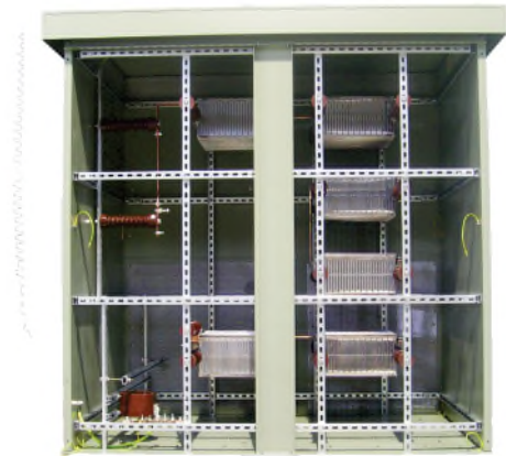
NOSPE-Widerstand im Stahlblechgehäuse 30kV, 2000A, 5s mit Trennlasche und Stromwandler Earthing resistor in a sheet steel enclosure 30kV, 2000A, 5s with disconnectable busbar and current transformer
