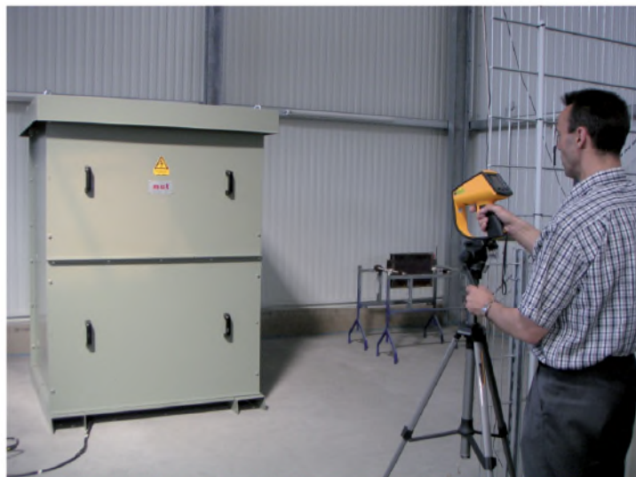
Wärmelauf eines Erdungswiderstandes in einem Gehäuse IP54 Heat conduction of an earth resistor in an IP54 housing
