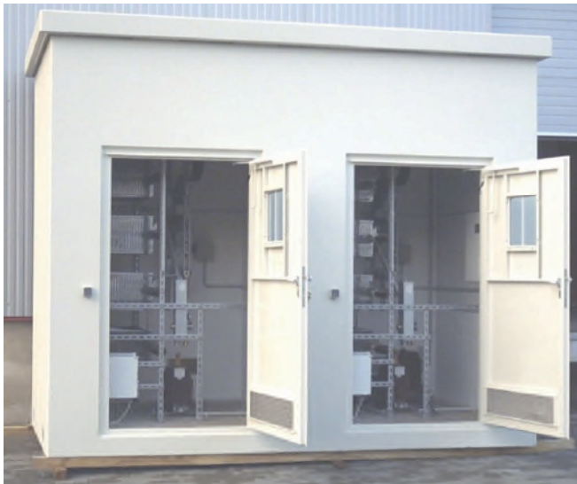
2 NOSPE-Widerstände in einer Betonstation 30kV, 2000A, 10s mit motorbetriebenen Lasttrennschaltern zur Sternpunktterdung an zwei Transformatoren 2 earthing resistors in a substation 30kV, 2000A, 10s with load break switches with motor drives for 2 transformers
